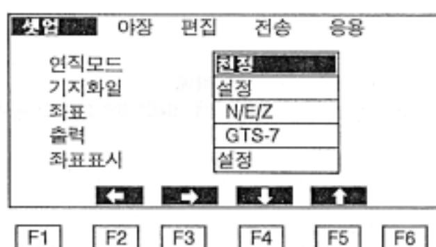
옵션화면의 항목들은 내정된 값을 가지고 있습니다. 옵션을 변경시키려면 【▶】와 【◀】를 사용합니다. 변경내용을 저장하고 빠져나오기 위해서는 맨 하단 항목으로 커서를 이동한 후 [ENT]키를 누릅니다. 변경내용을 취소하려면 [ESC]키를 누릅니다.
