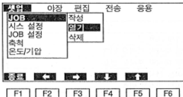
주메뉴는 화면 맨상단에 표시되며 부메뉴는 팝-다운 메뉴로 화면에 표시됩니다. 화면 맨 하단에 표시된 [◀] 와 [▶]는 주메뉴 사이의 이동시 사용됩니다. 또한 [▲] 와 [▼]키는 부메뉴의 바를 이동할 경우 주로 사용됩니다. 지정된 부메뉴를 선택할 경우 [ENT]키를 누릅니다.
